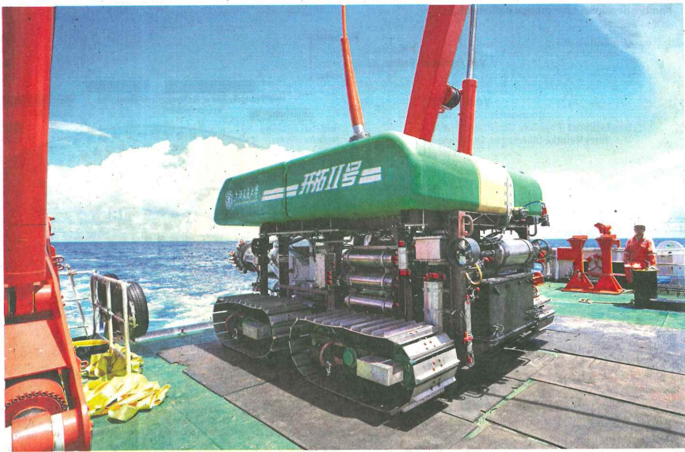
Le véhicule minier sous-marin lourd « Pioneer II », lors d'essais en mer de Chine, le 20 juin. SHANGHAI JIAO TONG UNIVERSITY/HANDOUT VIA XINHUA
